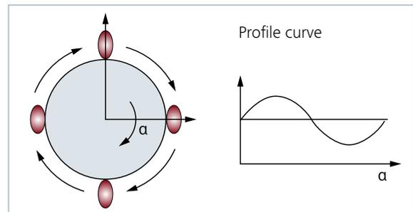
Die Tastkugel berührt das Werkstück an mehreren Stellen. → Dies hat einen kurvigen Profilverlauf aufgrund unterschiedlicher Antastpunkte zur Folge.
