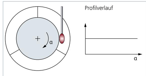
Die Tastkugel berührt das Werkstück nur an einer Stelle. → Dies hat einen geraden Profilverlauf aufgrund eines Antastpunktes zur Folge.
